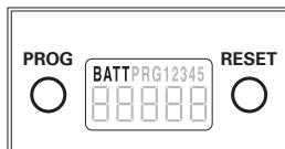
„BATT“ knippert wanneer de batterij bijna leeg is
