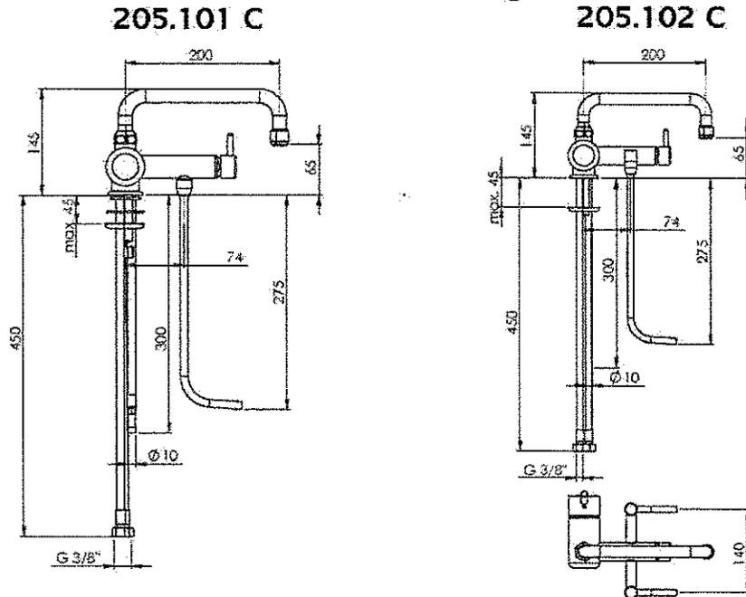
Bekanntlich dürfen offene Warmwasserbereiter nur mit Spezialarmaturen und geeignetem Zubehör verwendet werden.
